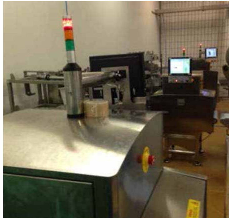
Máy MIDMEKI đang kiểm tra trong dây chuyền, MIDMEKI, được thiết kế dành cho các sản phẩm lớn hoặc nhiều sản phẩm nhỏ cùng lúc.
